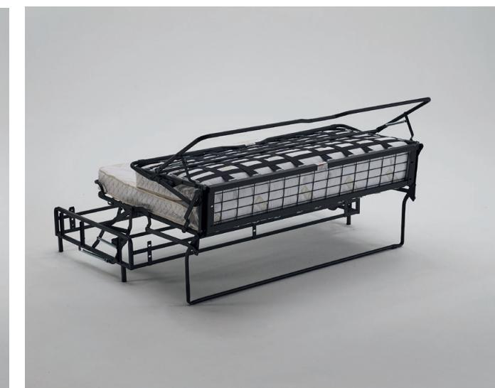
Meccanismo a due pieghe con apertura frontale ad estrazione. Al telaio reggi cuscino, di serie, si agganciano i cuscini della seduta, che non devono essere rimossi durante l'apertura e la chiusura. Il piano letto, con rete a maglia eletrosaldata, può accogliere materassi a molle, a molle insacchettate, in schiuma viscoelastica (14 x 190 cm) o in poliuretano espanso (12/13 x 190 cm). La seduta è con cinghie elastiche. Disponibile anche con barre laterali per inserimento. Piedini H 8 cm.
