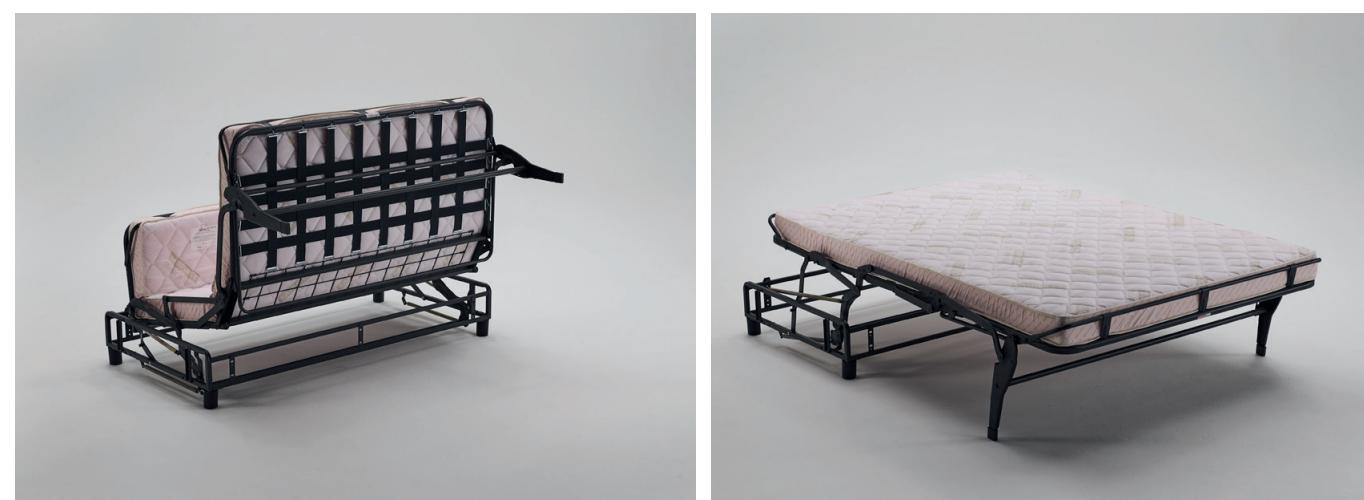
Meccanismo con apertura mediante rotazione della schienale e successivo svolgimento. La trasformazione in letto si realizza con un solo movimento senza rimuovere i cuscini della seduta e dello schienale. Solido e confortevole, col suo piano rete ortopedico in maglia eletrosaldato di 200 cm è adatto alla realizzazione di divani letto per uso quotidiano, per case, alberghi e comunità. Seduta con cinghie elastiche.
